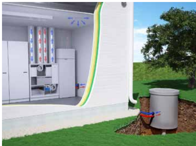
CG jordkylan utnyttjar jordvärmepumpens lösning för att kyla ner tilluften. CG jordkyla är ett ekologiskt sätt att kyla rumsluften på.
